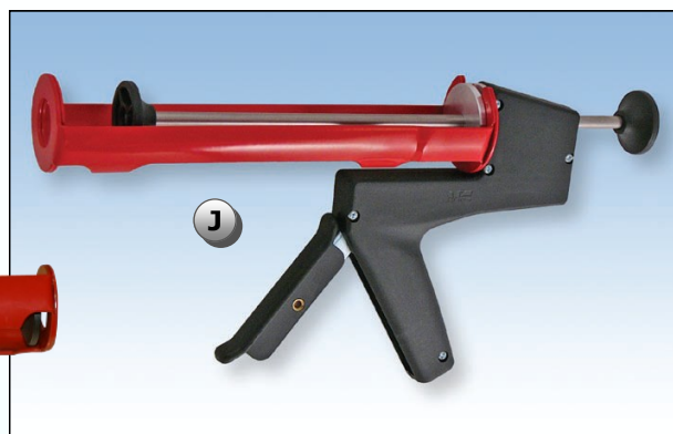
Professionel lim pistol med olietryk og udløserstop.
